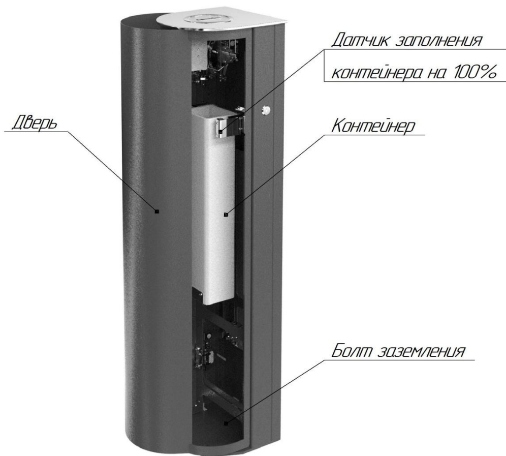
Контейнер картоприемника «Ростов-Дон КПМ»
